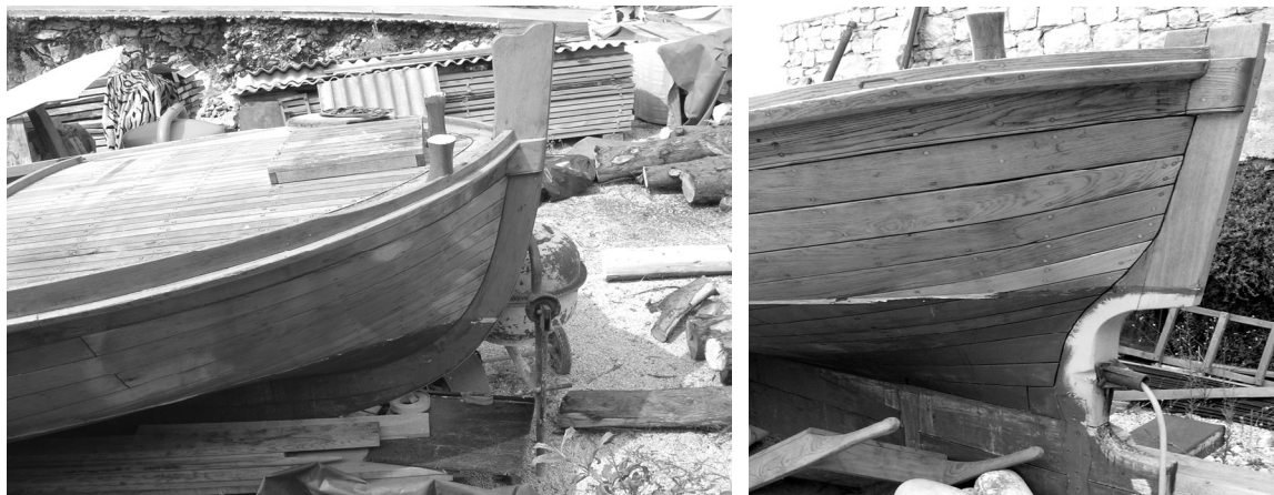
Slika 21 Pramac i krma korčulanske ribarice ( drveni čepovi na otvorima za prolaz čavala, ležaj osovine vijka, konstrukcijska vodna linija („ peškaj “), „ prva ruka “ laka i boje protiv obrastanja - „ koperpajna “)
