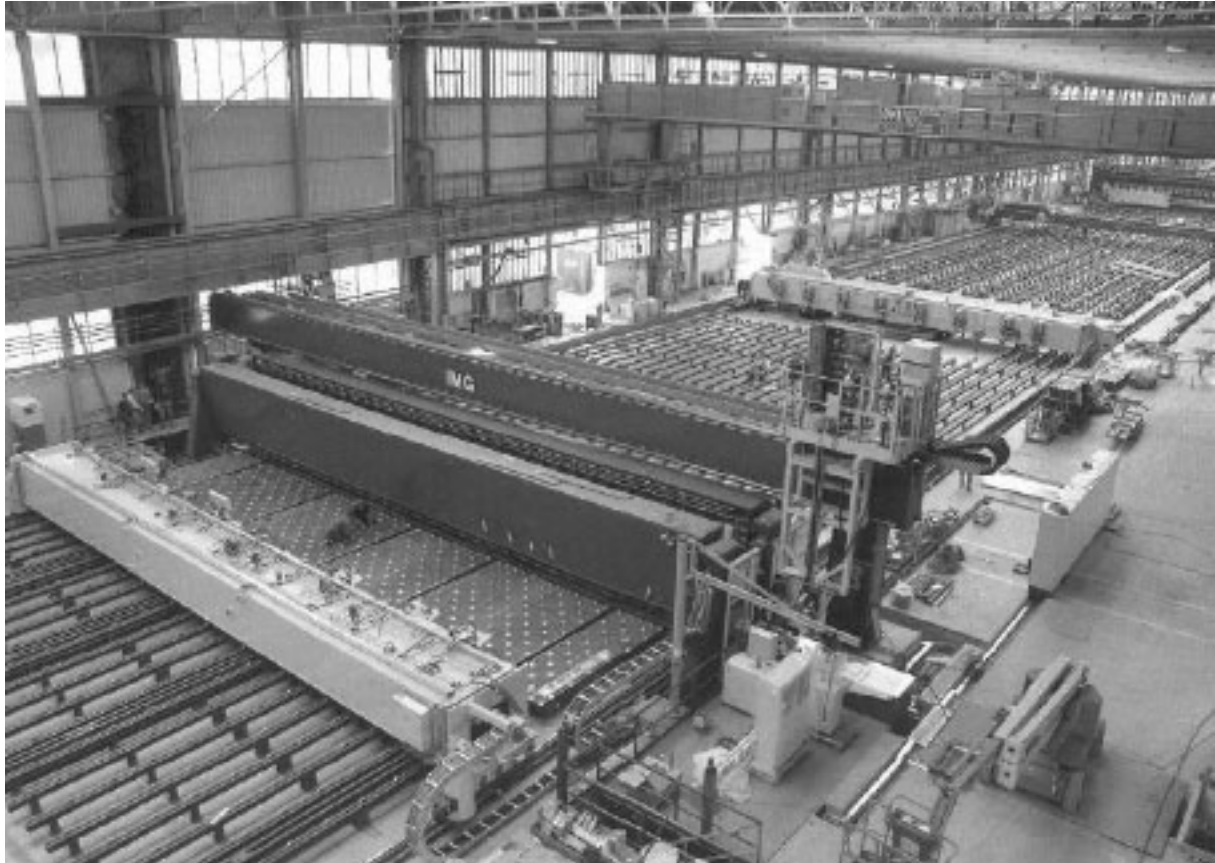
Slika 3. Linija za izradu tankih panela u Monfalcone - Italija
