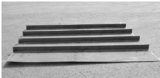
Slika 10. Izrada panela zavarivanjem pod praškom
