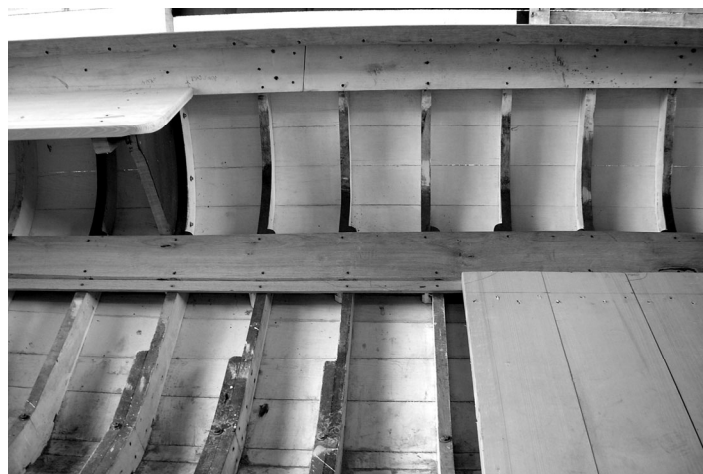
Slika 9 Položaji rebara, međurebrena polja, unutarnja uzvojna proveza („ verdžina “), podnice (brodoradiona I.Čulić-Lumbarda)
